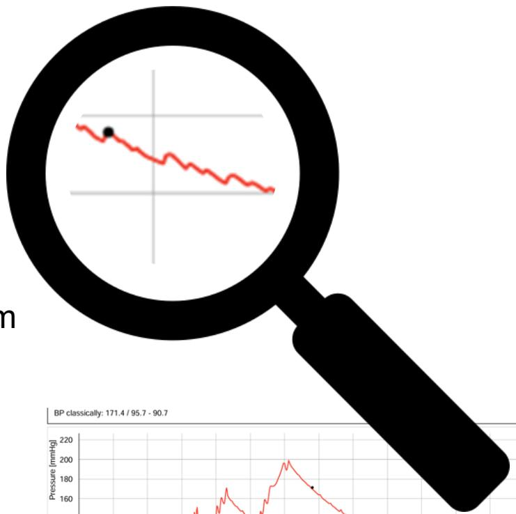
**1.** Im ersten Diagramm sehen Sie den Druckverlauf während der Messung in der Manschette. Zwei schwarze Markierungspunkte kennzeichnen die ermittelten Werte für Systole und Diastole.
